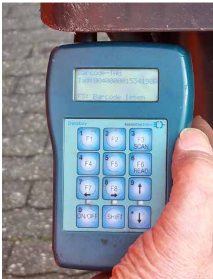
Der Transponder wird mit der Software über ein Lesegerät „verheiratet“
