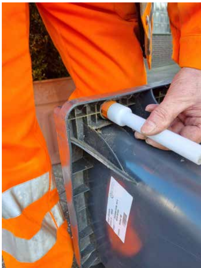
Einbau des Transponders in das „Nest“ unter dem Deckelrand – Der Aufkleber mit dem Barcode ist bereits angebracht.
