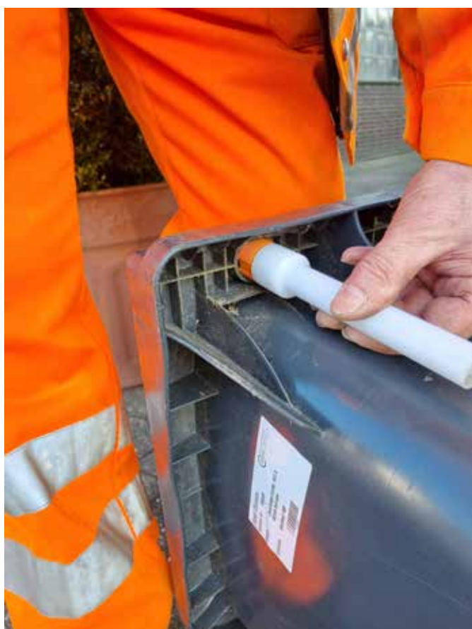
Einbau des Transponders in das „Nest“ unter dem Deckelrand – Der Aufkleber mit dem Barcode ist bereit angebracht.
